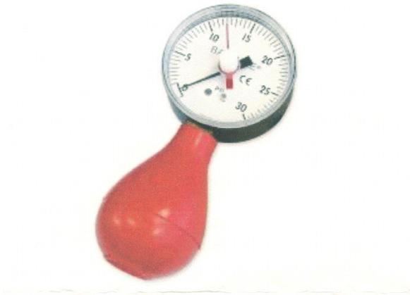
**Abbildung 23: Handkraftmessung mit Ballonmanometer**
