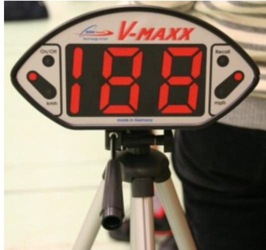
**Abbildung 4: V-MAXX Speed Radar Control, Gerät zur Messung der Wurfgeschwindigkeit in km/h**
